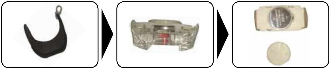
Das Rücklicht ist im hinteren Kotflügel eingesteckt, sensorgesteuert und lässt sich nicht manuell ein- / ausschalten.
