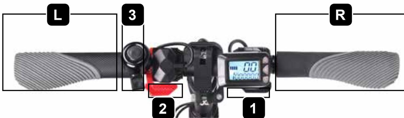
Daumengas (1), elektrische Bremse (2) und Klingel (3) sind bereits vorinstalliert.
